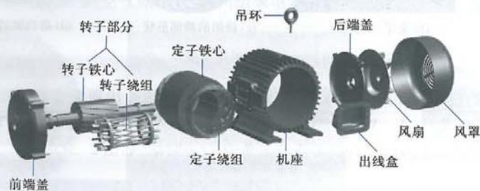
图 2-2 三相异步电动机结构分解
