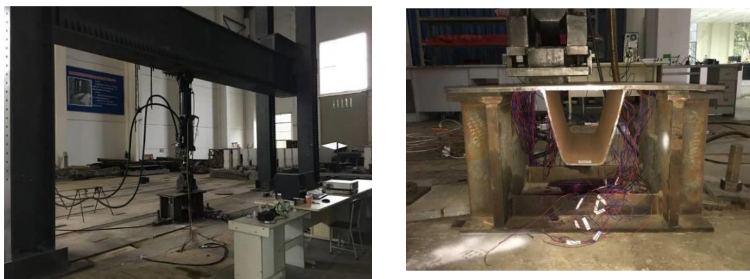
图 13 《正交异性钢桥面板厚边 U 肋疲劳性能试验研究》试验现场
